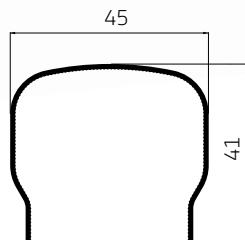
Создает модульную систему с профилем AP 208.
