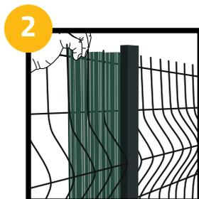
Nous faisons glisser les lattes latérales et principales verticalement et les montons dans profil d'attache.
