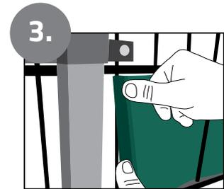
Wir befestigen den Endclip mit den Sichtschutzstreifen an der Platte.
