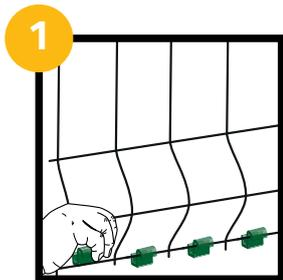
Wir installieren Montageclips mit Hauptleiste an der unteren horizontaler Draht.
