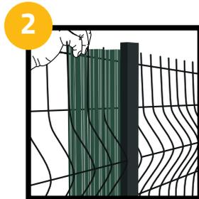
Wir setzen die Neben- und Hauptleisten an und montieren sie in Clips.
