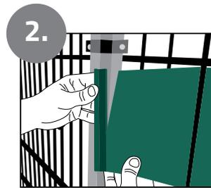
Wir befestigen das Klebeband im Endclip.
